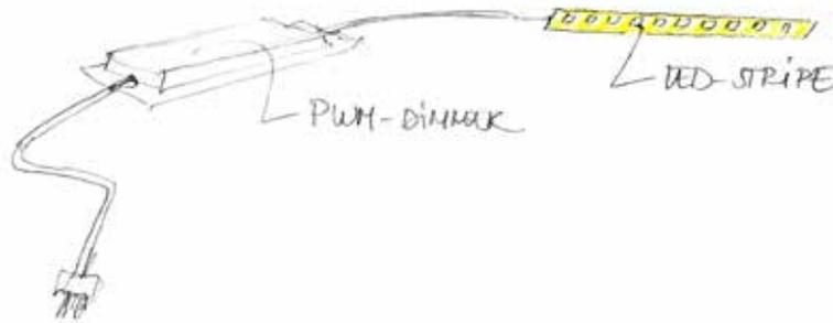
Bei größeren Installationen, die an eine gemeinsame Steuerung angeschlossen werden sollen, kann es wirtschaftlicher sein, nach alternativen Lösungen zu suchen. Eine der Alternativen ist eine herkömmliche Stromversorgung und mehrere daran angeschlossene externe Steuerungen. Es ist eine ideale Wahl für Installationen bis zu 10A.
